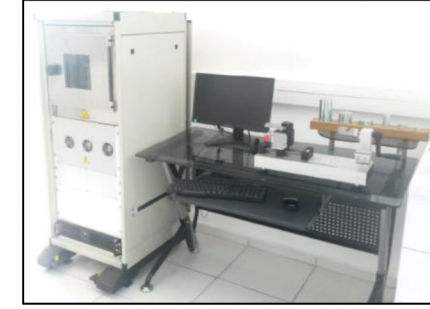
Şekil 4.b Pulse Di-Elektrik kontrolü (1800-2500 V altında 20 Kilo Herz frekanslık darbelerle telin izolasyon dayanımının kontrolü)
