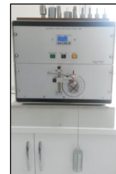
Şekil 4.a Geri Yayılanma Açısı Kontrolü (Telin form verilebilirlik kontrolü)
