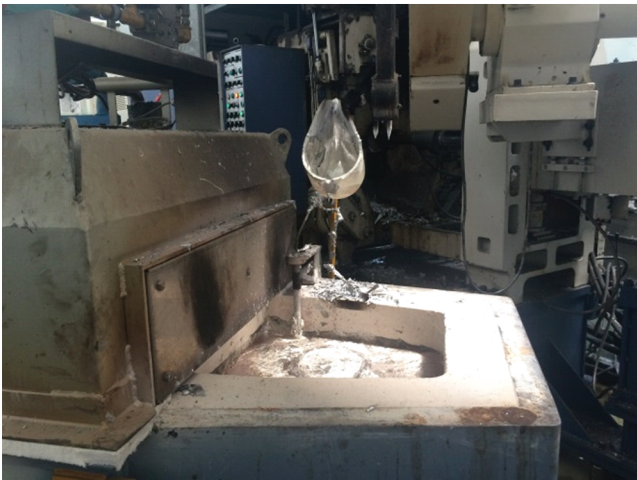
Şekil 5. Otomatik kepçeli bekletme potaları (Volt Elektrik Motorları).
