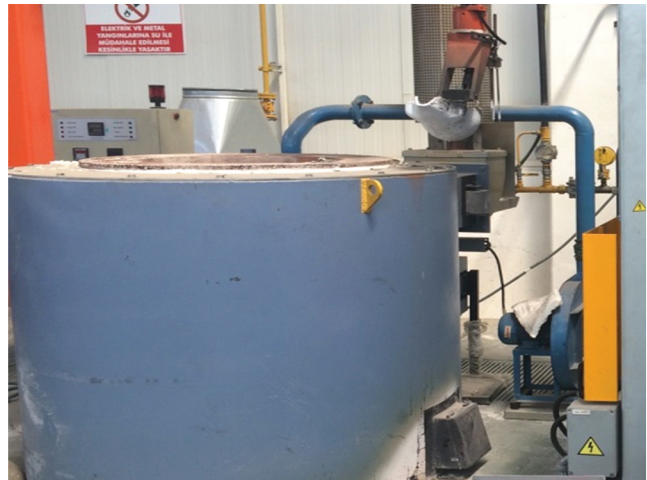
Şekil 5. Otomatik kepçeli bekletme potaları (Volt Elektrik Motorları).
