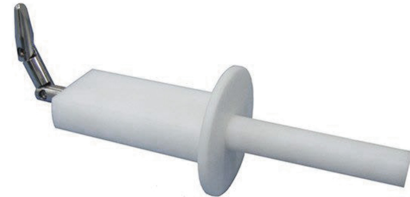
Şekil 3 Canlı Kısımlar, Kaplamalı Teller ve Hareketli Parçalara Erişebilirlik Testlerinde Kullanılan Prob Örneği
