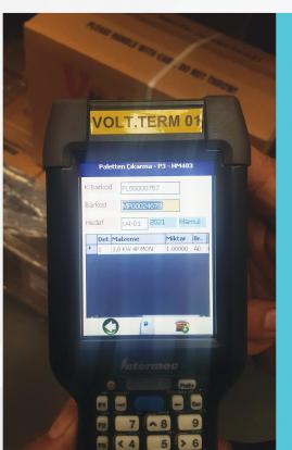
Depo da FIFO yaklaşımı ile açılan teslimatların toplanması, kontrol edilmesi ve sevk edilmesi tamamen barkod kontrollü hale getirildi. Üretim aşamasında uygulanan seri takibi, sevkiyat aşamasında uygulanabilir hale getirildi.
